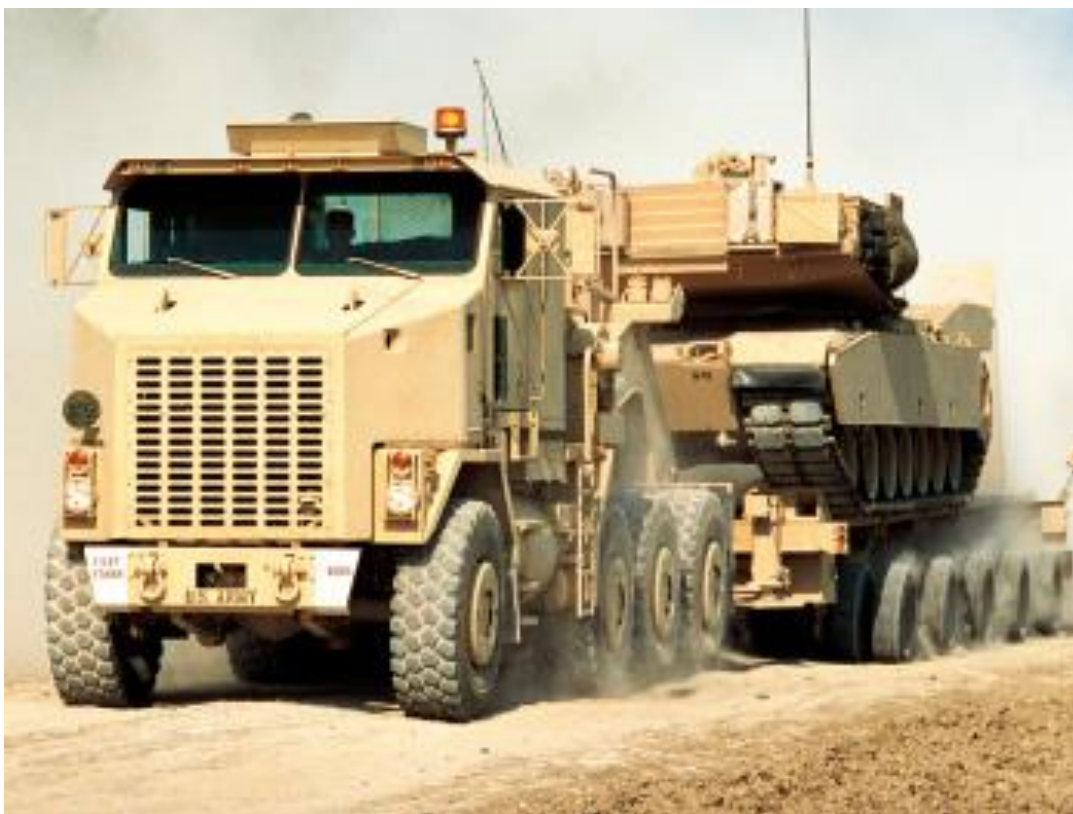
Oshkosh (Ошкош) HET (M1070) '1992–2003 ТТХ: 500 л.с., АКПП (Allison), постоянный полный привод
